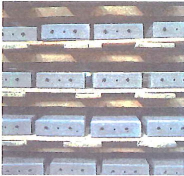
Les pavés sont cuits pendant trente heures à plus de 1 000 degrés
